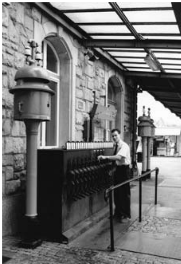
Das Freigabewerk (Baujahr 1910) vor dem Stationsgebäude wurde 1996 durch ein elektrisches im Stationsbüro ersetzt
